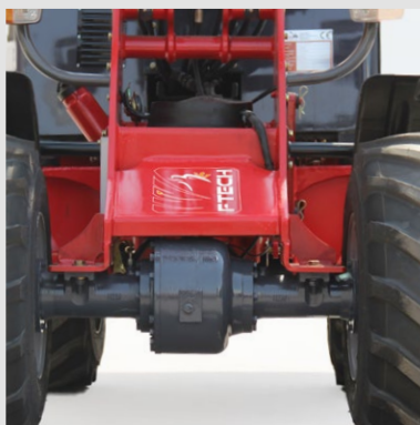
Frei zuschaltbare Differenzialsperre für maximale Kraftübertragung
