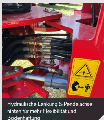
Hydraulische Lenkung & Pendelachse hinten für mehr Flexibilität und Bodenhaftung
