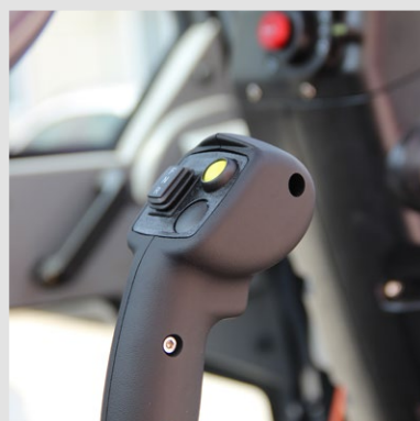
Joystick-Steuerung und elektronische Gangschaltung
